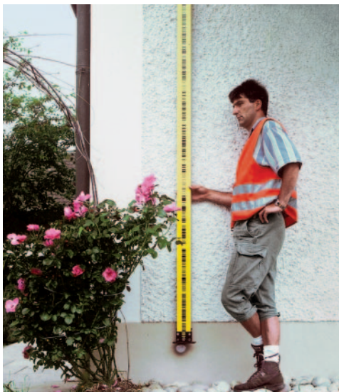
Nivellierlatte in Messstellung auf einem Höhenfestpunkt. Die Millimeter-Teilung der Latte ist in einem digitalen Code verschlüsselt und befindet sich auf einem Lattenteil, der keine thermische Ausdehnung erfährt.
